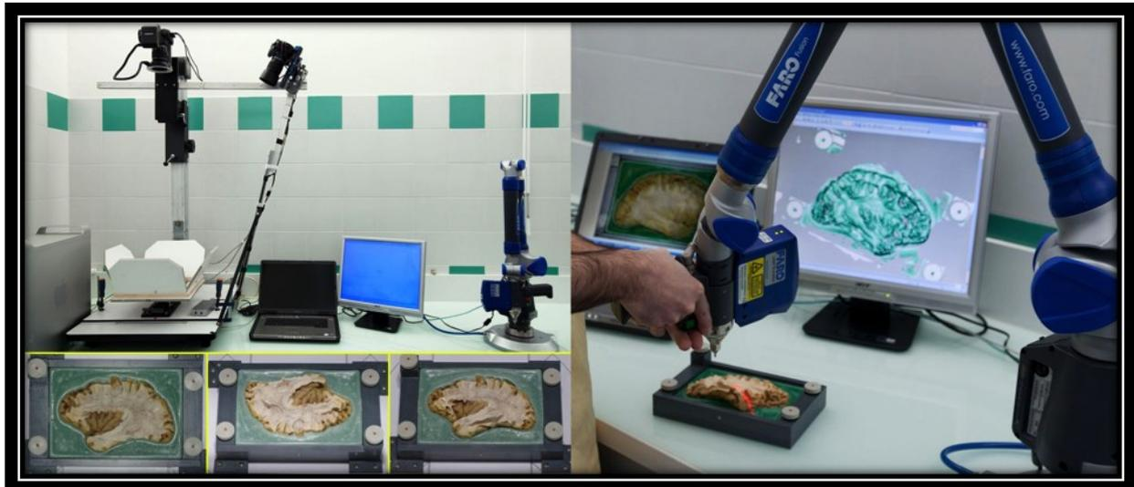
Figure 28. Poste de travail pour les acquisitions de surface en cours de dissection. Les 2 appareils photographiques permettaient une acquisition de l'information de texture des spécimens anatomiques. Le scanner laser permettait l'acquisition de la surface disséquée.
