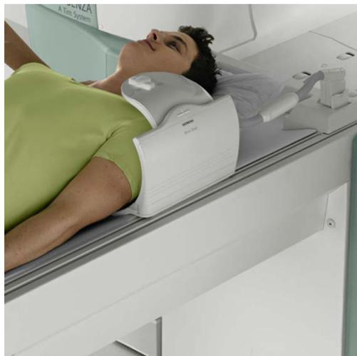
*Figure 3-6 : Photographie d'une antenne dédiée à l'exploration de l'épaule. Image tirée du site <https://www.healthcare.siemens.com>.*
