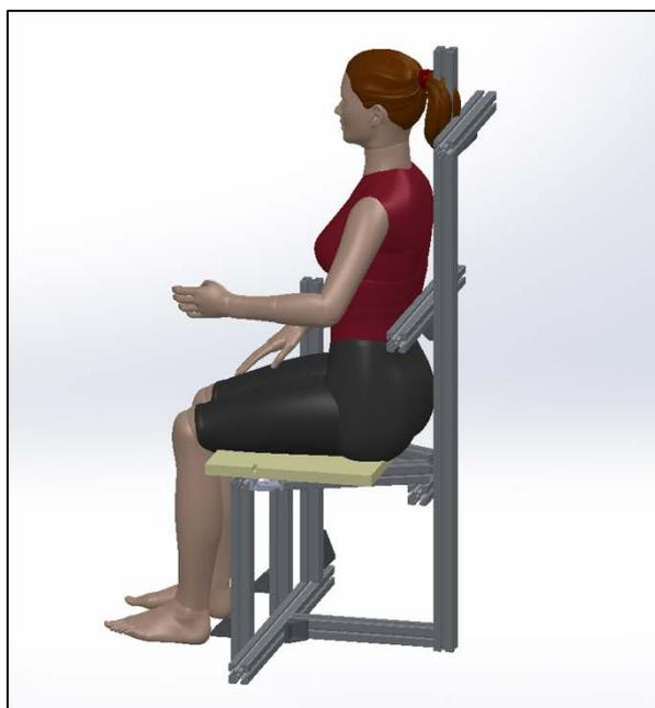
*Figure 4-7 : Dessin sur SoliWorks™ du premier modèle du banc de contrainte et du sujet positionné. Noter le dossier réduit à une barre verticale centrale donnant plein accès à la face postérieure de l'épaule.*
