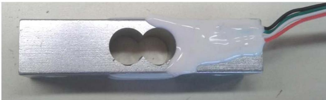
*Figure 4-10 : Photographies du capteur de force à jauge CZL635-20. La flèche verte indique la direction de la contrainte à appliquer pour une mesure valide. Noter la présence des jauges recouvertes de silicone blanc de part et d'autre de la zone d'élasticité du corps d'épreuve (trous).*
